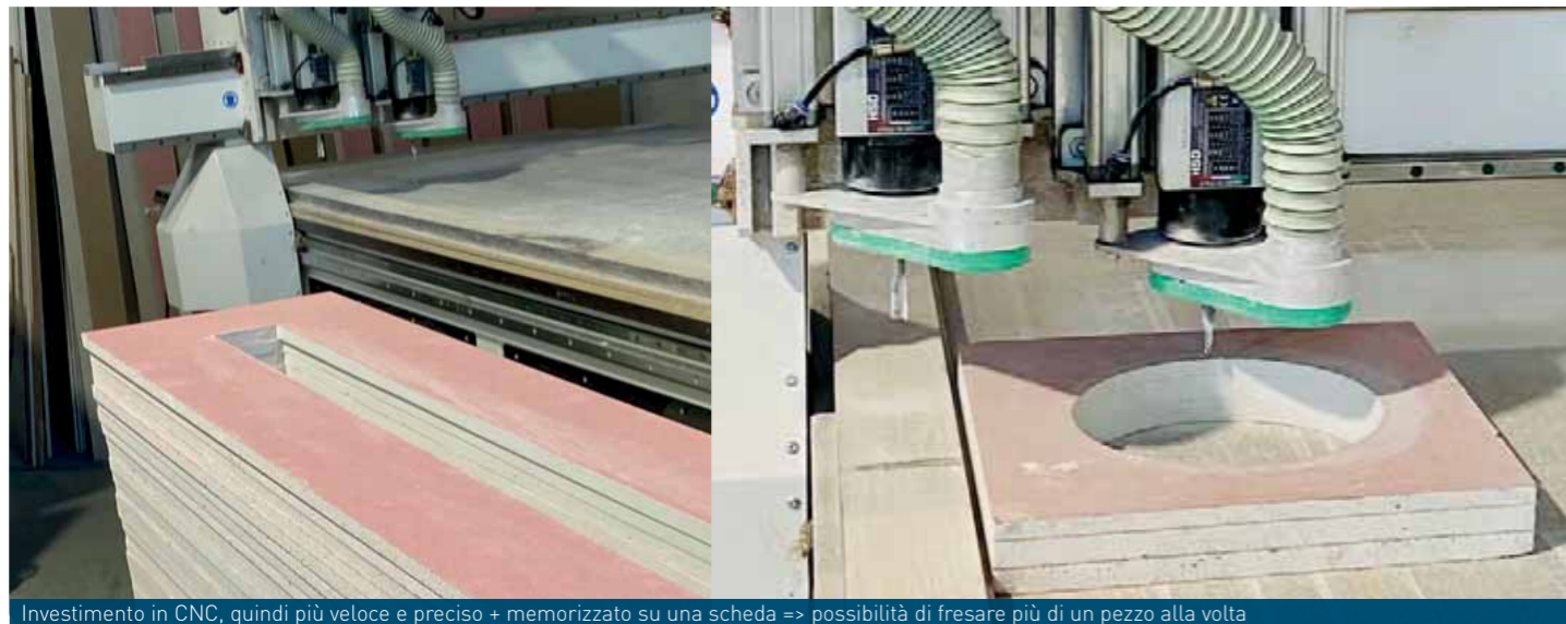
Investimento in CNC, quindi più veloce e preciso + memorizzato su una scheda => possibilità di fresare più di un pezzo alla volta
